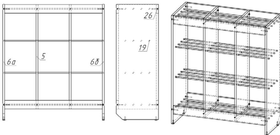
**Примечание:** В процессе эксплуатации происходит ослабление болтового соединения. Во избежание расшатывания и преждевременного износа изделия необходимо периодически подкручивать болтовые соединения.
