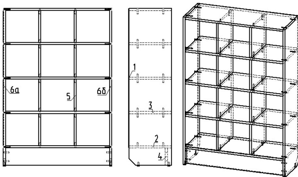
**Примечание:** В процессе эксплуатации происходит ослабление болтового соединения. Во избежание расшатывания и преждевременного износа изделия необходимо периодически подкручивать болтовые соединения.
