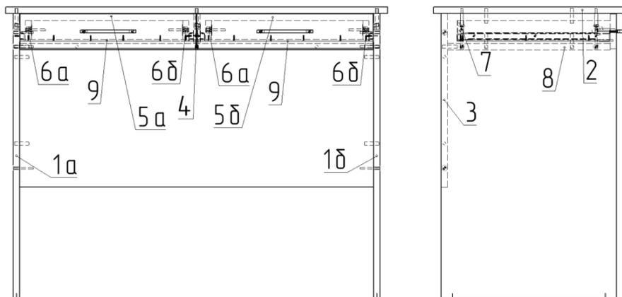
**Примечание:** В процессе эксплуатации происходит ослабление болтового соединения. Во избежание расшатывания и скрипа изделия необходимо периодически подкручивать гайки.
