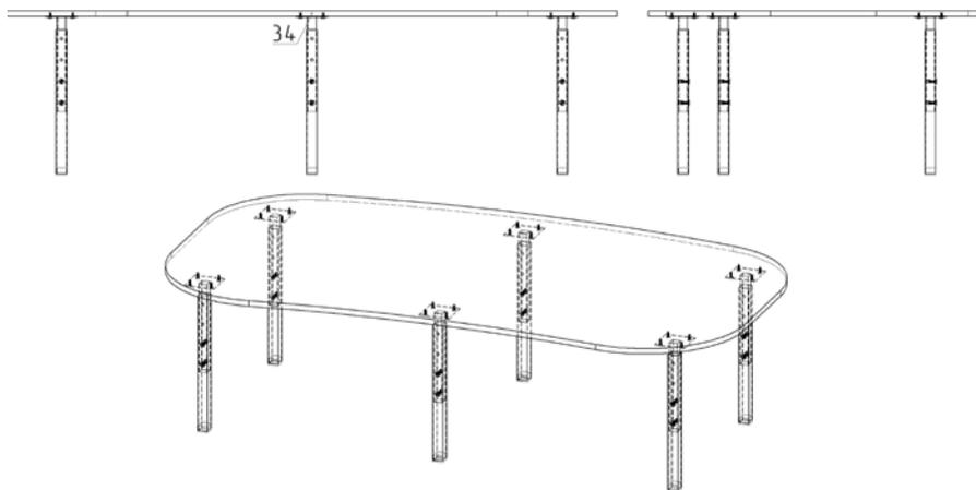
**Примечание:** В процессе эксплуатации происходит ослабление болтового соединения. Во избежание расшатывания и скрипа изделия необходимо периодически подкручивать гайки.
