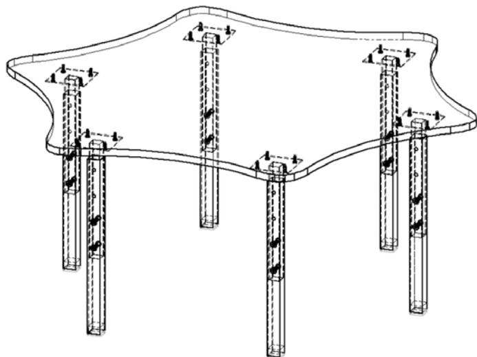
**Примечание:** В процессе эксплуатации происходит ослабление болтового соединения. Во избежание расшатывания и скрипа изделия необходимо периодически подкручивать гайки.
