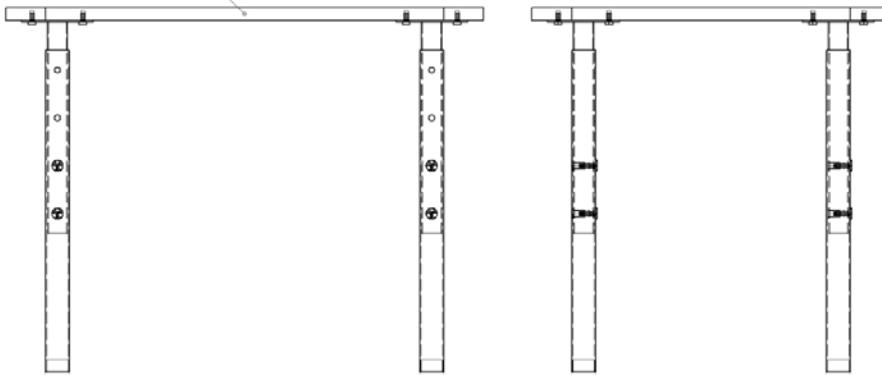
**Примечание:** В процессе эксплуатации происходит ослабление болтового соединения. Во избежание расшатывания и скрипа изделия необходимо периодически подкручивать гайки.
