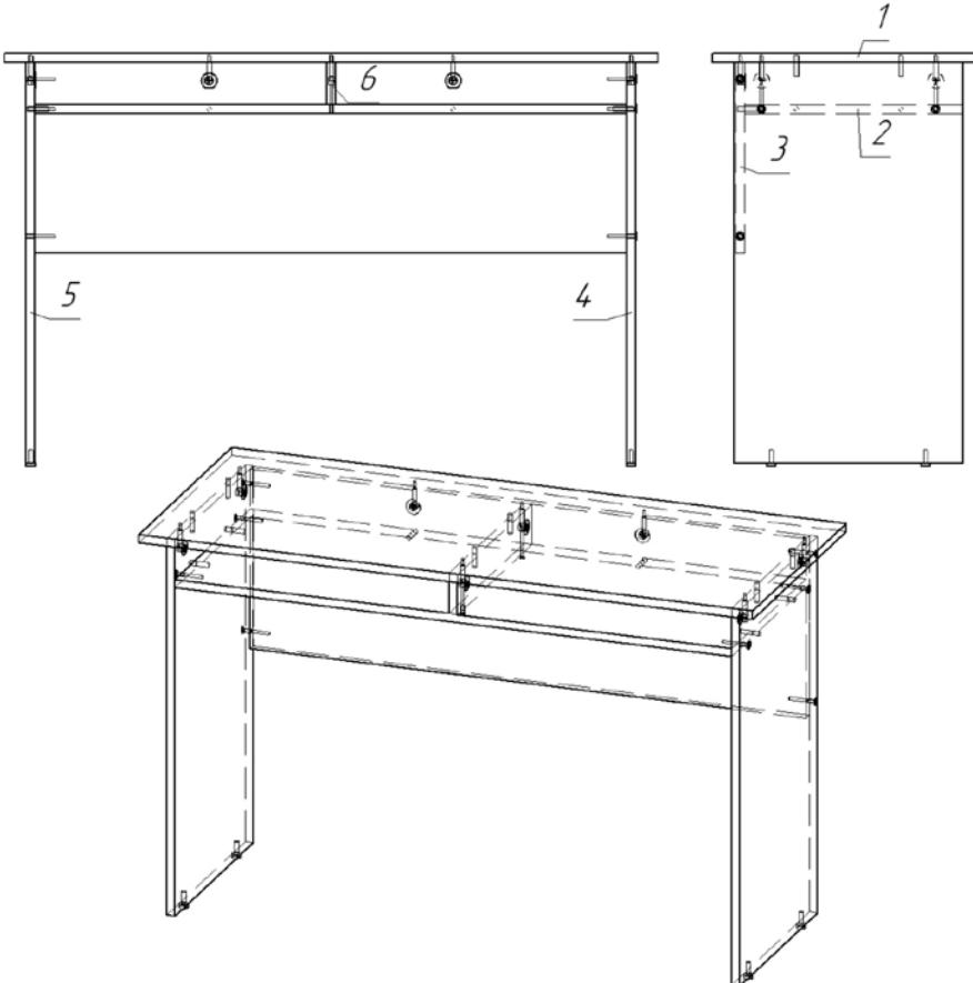
**Примечание:** В процессе эксплуатации происходит ослабление болтового соединения. Во избежание расшатывания изделия необходимо периодически подкручивать эксцентрики.
