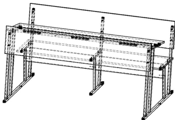
**Примечание:** В процессе эксплуатации происходит ослабление болтового соединения. Во избежание расшатывания изделия необходимо периодически подкручивать эксцентрики.
