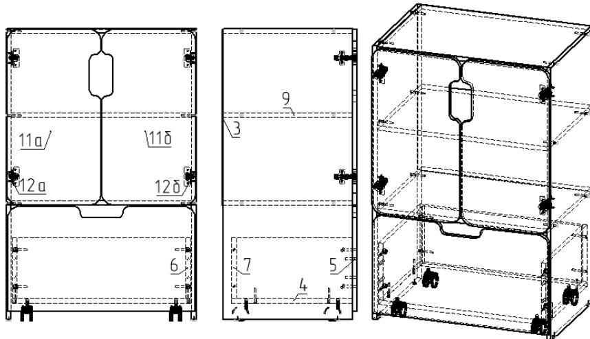
**Примечание:** В процессе эксплуатации происходит ослабление болтового соединения. Во избежание расшатывания и преждевременного износа изделия необходимо периодически подкручивать болтовые соединения.
