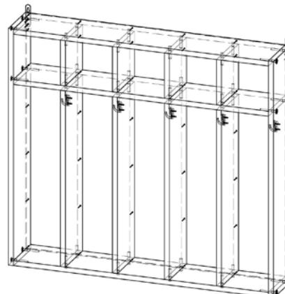
**Примечание:** В процессе эксплуатации происходит ослабление болтового соединения. Во избежание расшатывания и преждевременного износа изделия необходимо периодически подкручивать болтовые соединения.
