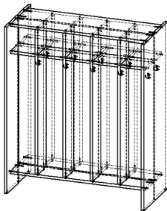
**Примечание:** В процессе эксплуатации происходит ослабление болтового соединения. Во избежание расшатывания и преждевременного износа изделия необходимо периодически подкручивать болтовые соединения.
