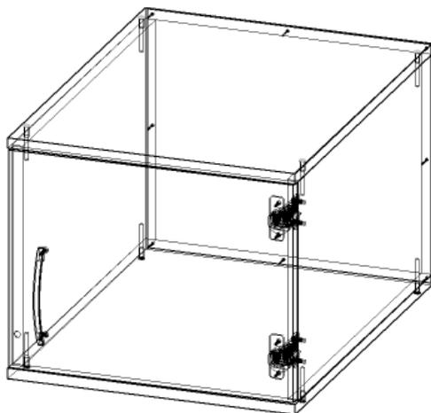
**Примечание:** В процессе эксплуатации происходит ослабление болтового соединения. Во избежание расшатывания и скрипа изделия необходимо периодически подкручивать гайки.
