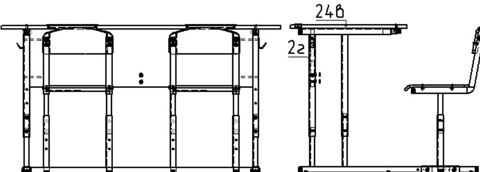
**Примечание:** В процессе эксплуатации происходит ослабление болтового соединения. Во избежание расшатывания и скрипа изделия необходимо периодически подкручивать гайки.
