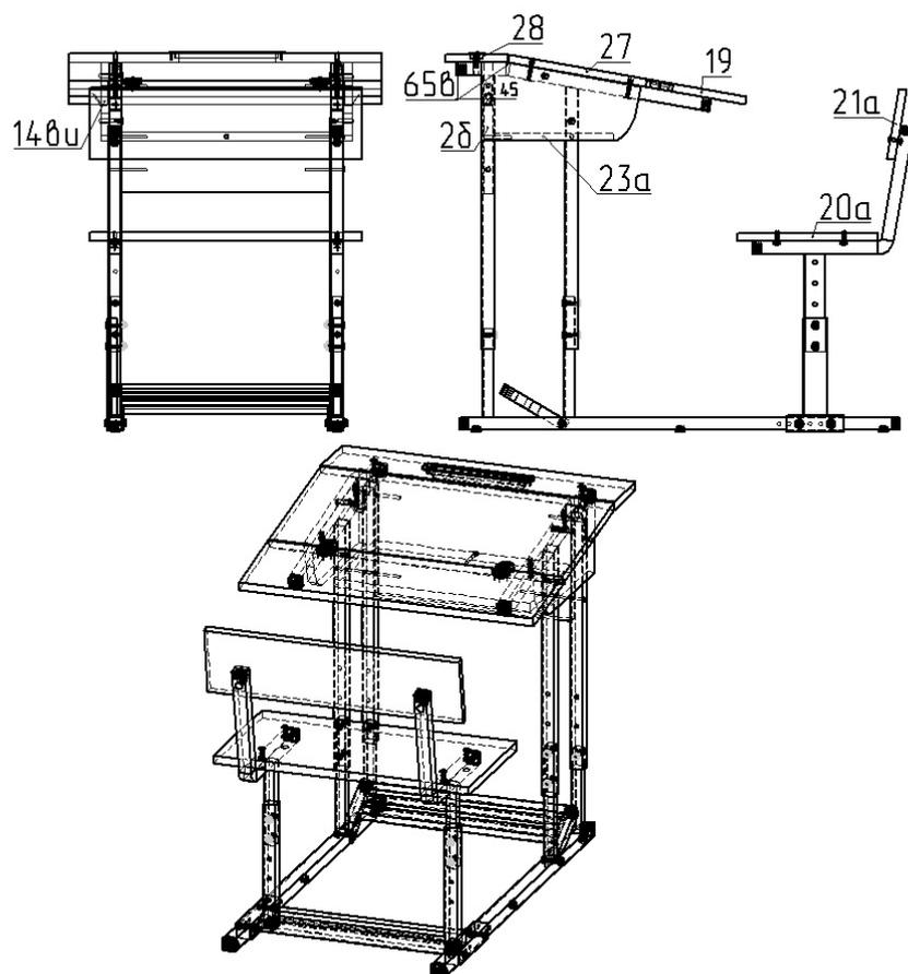
Регулировку изделия по ростовым группам следует производить до начала сборки. Регулировка собранного стола по высоте выполняется следующим образом: **1.** Раскрутить болтовое соединение в стойках стола. Выполнить регулировку на требуемую ростовую группу. **2.** Зажать все винтовые соединения.
