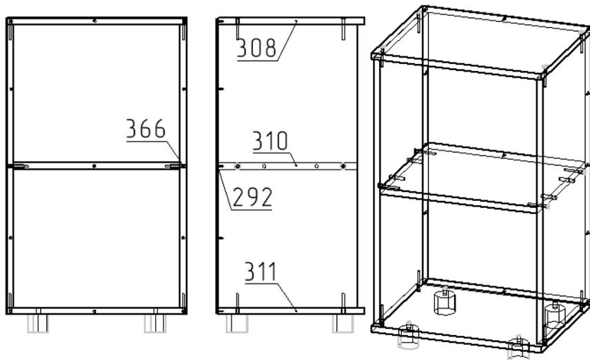
**Примечание:** В процессе эксплуатации происходит ослабление болтового соединения. Во избежание расшатывания и скрипа изделия необходимо периодически подкручивать гайки.
