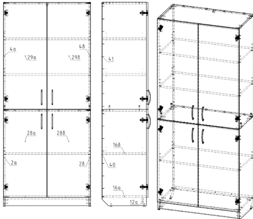
**Примечание:** В процессе эксплуатации происходит ослабление болтового соединения. Во избежание расшатывания и скрипа изделия необходимо периодически подкручивать гайки.
