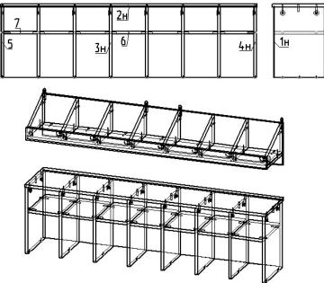
Примечание: В процессе ослабление болтового соединения. Во избежание расшатывания и преждевременного износа изделия подкручивать болтовые соединения.
