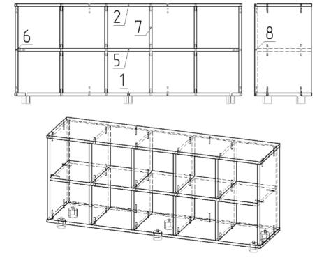
**Примечание:** В процессе эксплуатации происходит ослабление болтового соединения. Во избежание расшатывания и преждевременного износа изделия необходимо периодически подкручивать болтовые соединения.
