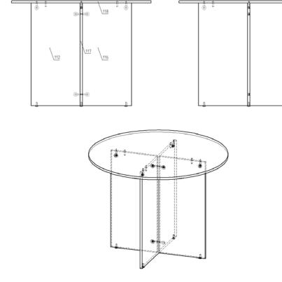
**Примечание:** В процессе эксплуатации происходит ослабление болтового соединения. Во избежание расшатывания и скрипа изделия необходимо периодически подкручивать гайки.
