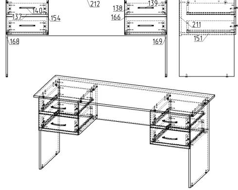
Примечание: В эксплуатации процессе происходит ослабление болтового соединения. Во избежание расшатывания и преждевременного износа изделия необходимо периодически подкручивать болтовые соединения.
