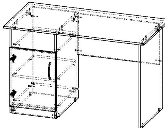
**Примечание:** В процессе эксплуатации происходит ослабление болтового соединения. Во избежание расшатывания и преждевременного износа изделия необходимо периодически подкручивать болтовые соединения.
