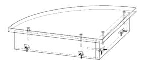
**Примечание:** В процессе эксплуатации происходит ослабление болтового соединения. Во избежание расшатывания изделия необходимо периодически подкручивать эксцентрики.
