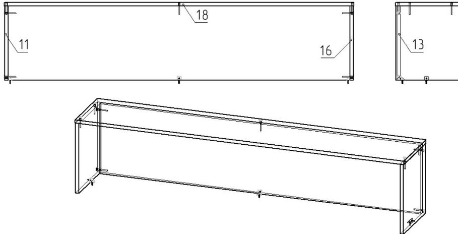
**Примечание:** В процессе эксплуатации происходит ослабление болтового соединения. Во избежание расшатывания и преждевременного износа изделия необходимо периодически подкручивать болтовые соединения.
