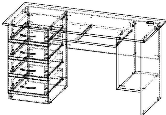
**Примечание:** В процессе эксплуатации происходит ослабление болтового соединения. Во избежание расшатывания и скрипа изделия необходимо периодически подкручивать гайки.
